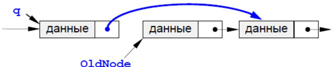
Рис. 8.5. Удаление узла
