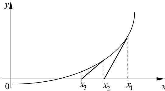
Рис. 2.4. Решение уравнения методом касательных
